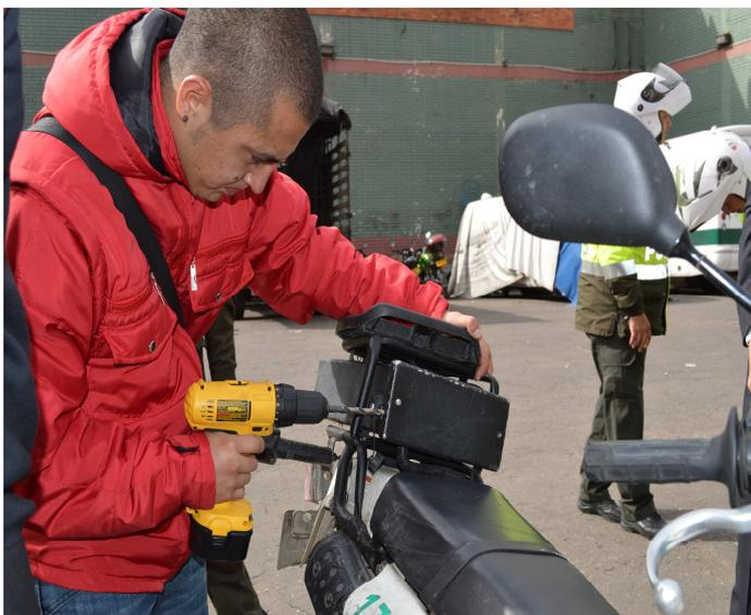
*Para descargar los videos se debe desarmar la carcasa o Housing ya que el conector RJ45 exterior, esta deteriorado*
