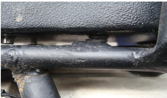
*Al no tener sistema de amortiguación hace que el soporte en donde se aloja el DVR Móvil rompa constantemente la estructura de apoyo*
