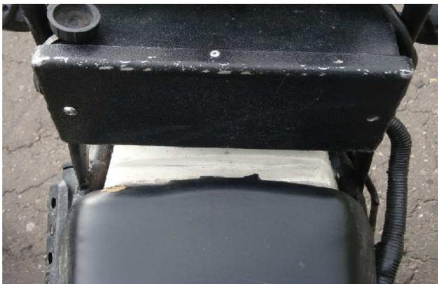
*No existe un sistema de amortiguación adecuado que soporte las vibraciones que produce la moto*
