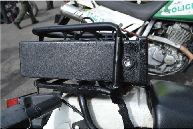
*En la imagen se observa que el Housing está dispuesto de manera inadecuada, ya que el parrillero queda incomodo contra la caja metálica*
