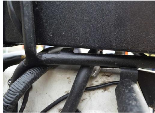
Las soldaduras hechas para la instalación del gabinete del DVR se encontraban en mal estado, con terminados antiestéticos, demostrando además que la calidad esperada no corresponde a la instalada.
